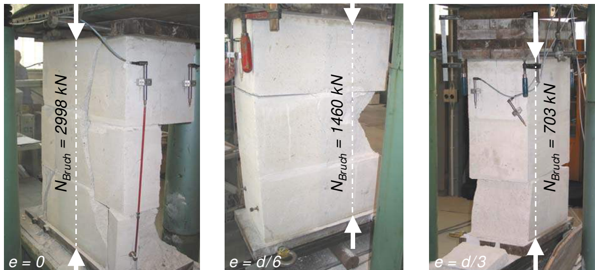
Fig. 7: Versuche zur Querschnittstragfähigkeit unter mittiger und ausmittiger Belastung [4]
