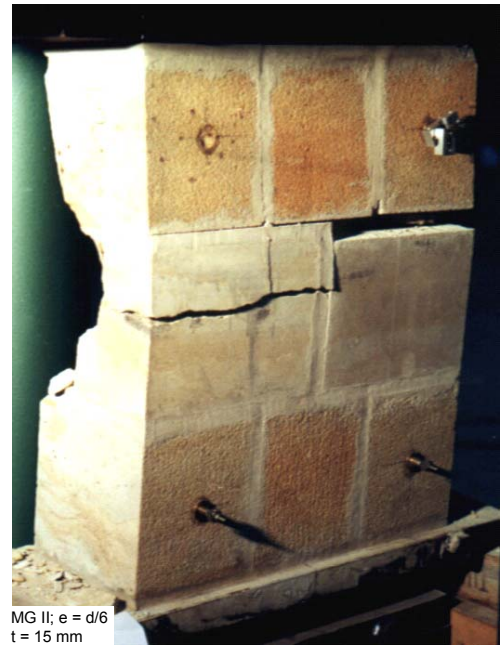
c) Seitenansicht zu dem Bruchbild nach b)
