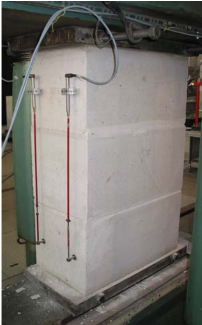
a) Lagerung des Versuchskörpers unter zentrischer Belastung
