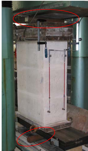
b) Lagerung des Versuchskörpers unter exzentrischer Belastung
