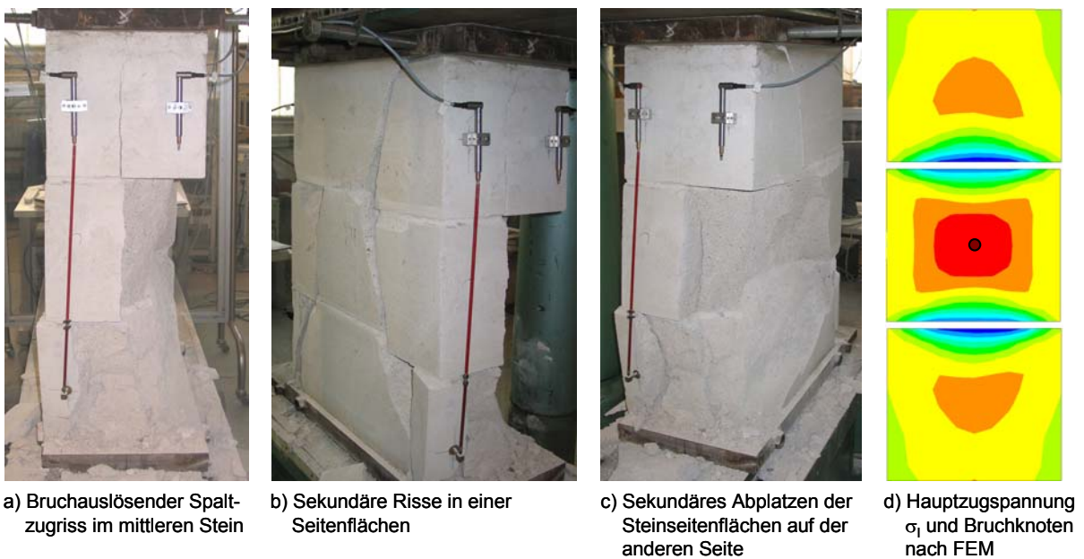
Abb. 8-3: Bruchbilder des Druckversuches unter zentrischem Lastangriff
