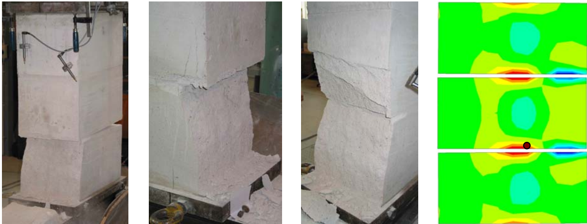
a) Versagen des unteren Steins im Bruchmoment
