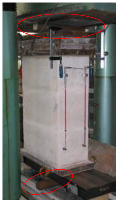
b) Lagerung des Versuchskörpers unter exzentrischer Belastung
