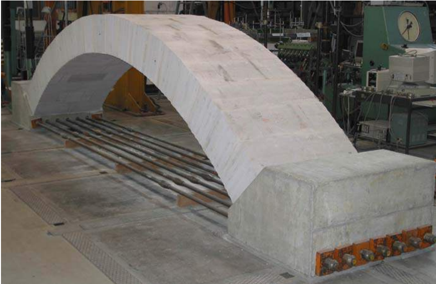
Abb. E-2: Gegenseitig verspannte Widerlager zur Aufnahme des Bogenschubs
