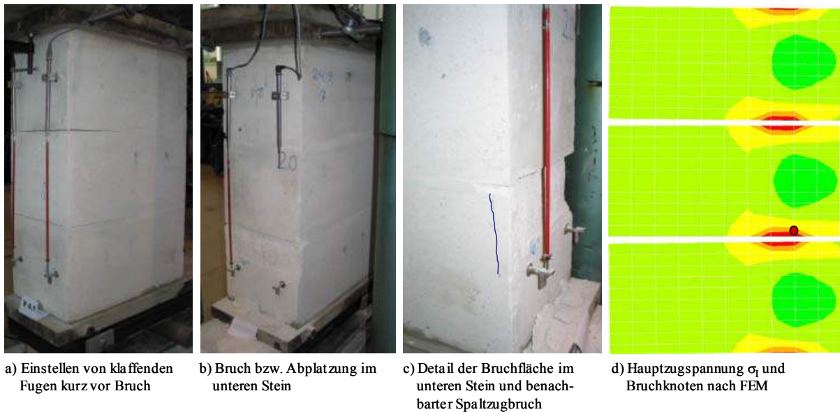
Abb. D-7: Bruchbilder des Druckversuches unter exzentrischem Lastangriff bei m = 2,5
