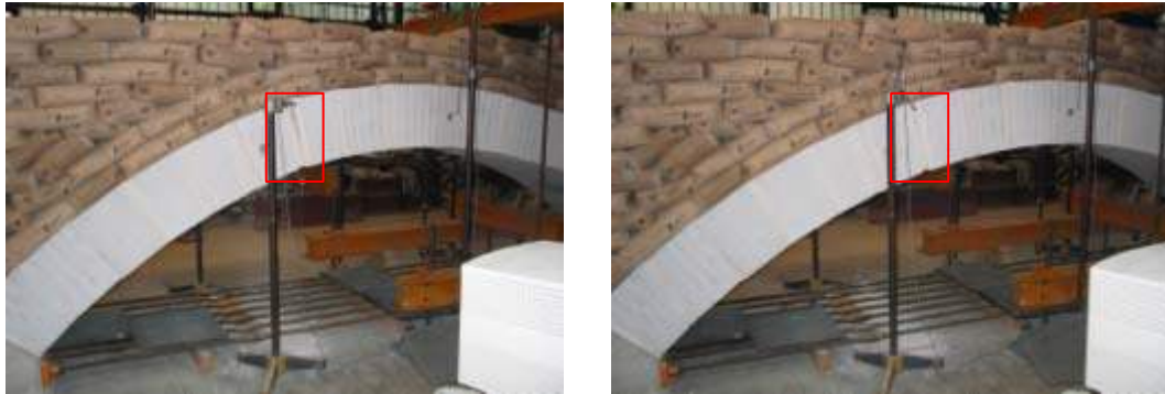
a) Klaffende Fuge im Moment des Erreichens der Traglast infolge Gelenkkette b) Schließen der Fuge nach Entlastung
