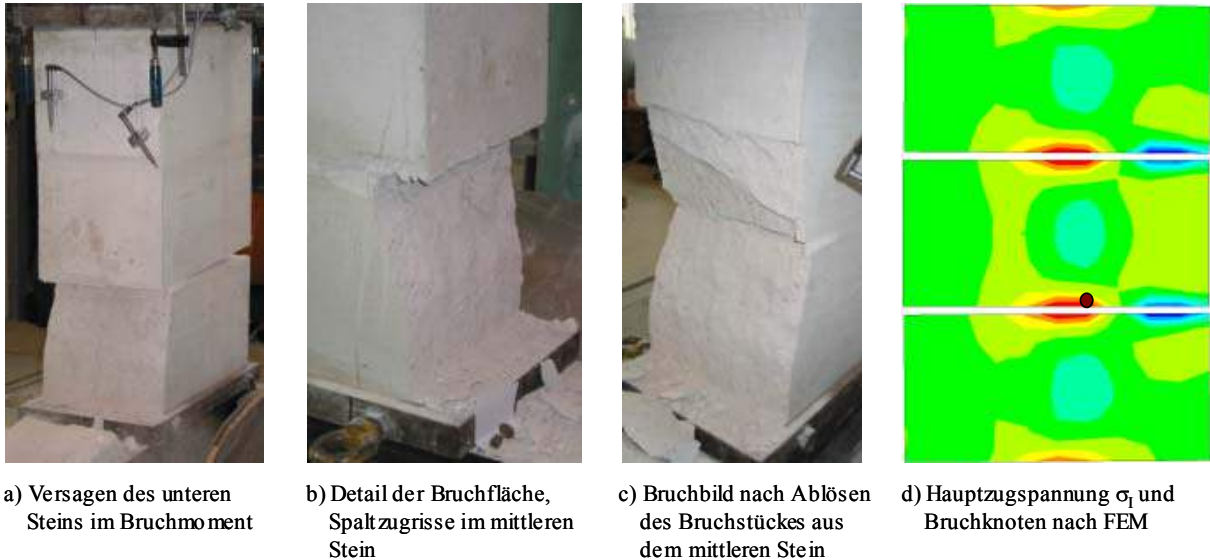
Abb. D-6: Bruchbilder des Druckversuches unter exzentrischem Lastangriff bei m = 2,0
