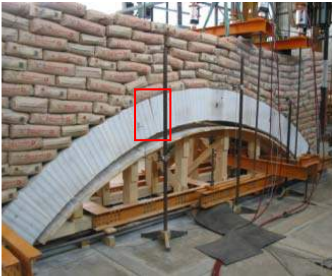
a) Klaffende Fuge im Moment des Erreichens der Traglast infolge Gelenkkette
