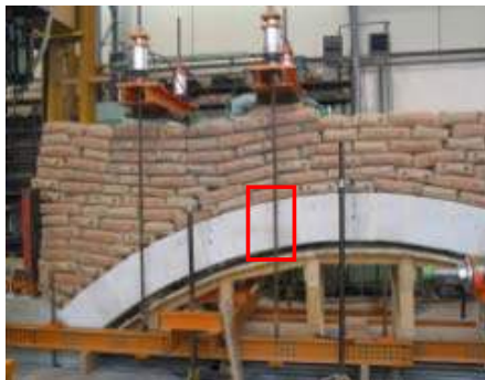
a) Bereich des aufgetretenen Risses
