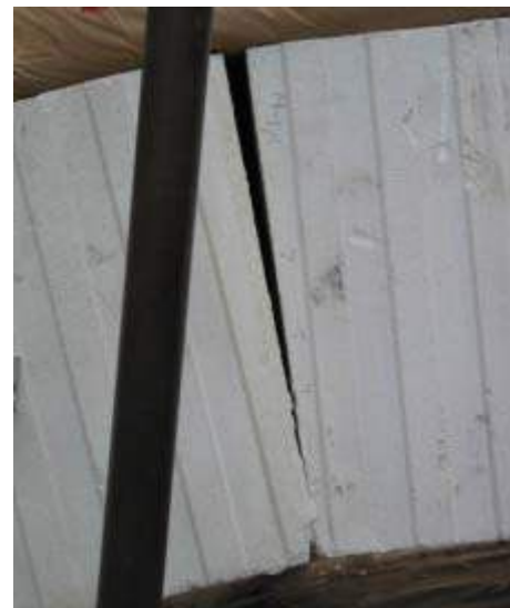
b) Einschnürung des überdrückten Fugenbereichs und Bildung eines Gelenks
