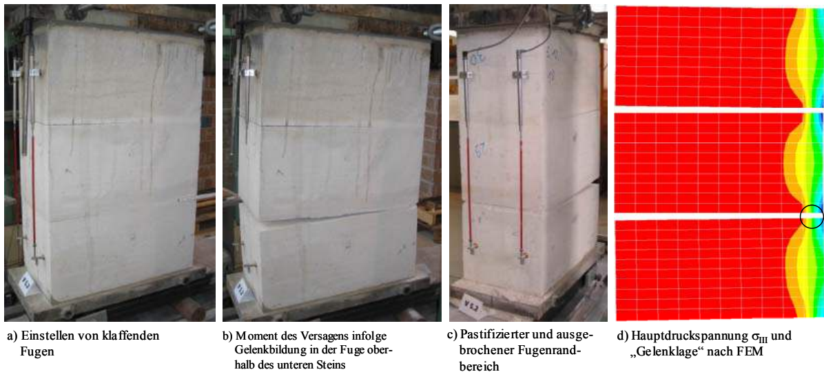
Abb. D-8: Bruchbilder des Druckversuches unter exzentrischem Lastangriff bei m = 2,7
