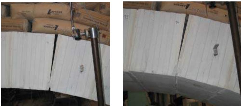
a) Klaffende Fuge im Moment des Erreichens der Traglast infolge Gelenkkette
